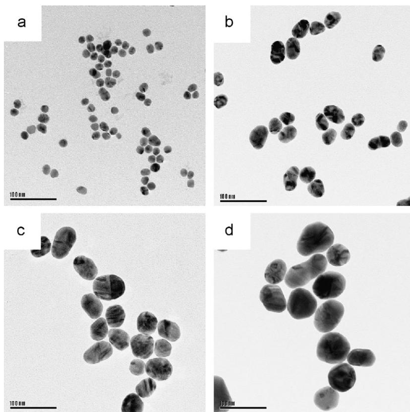
Fig. 1. TEM images of Au nanoparticles: (a) 13 nm, (b) 35 nm, (c) 45 nm and (d) 68 nm.
